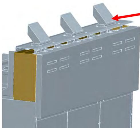
ステップ3：煙道デフレクタ（8239025）として図示をインストールしてください。
