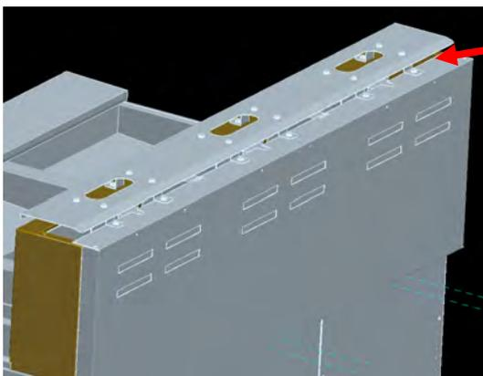
ステップ2：キャビネットのネジを使用して、ライザーへのインストールカバープレート（2601155）（8090434）。角度のついた傾斜がフライヤーの背面にあることを確認してください。90°コーナーは、フライヤーの正面を向いてしなければなりません。
