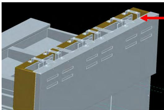
ステップ1：キャビネットのネジを使用して、煙道ライザー（2601156）をインストールします（8090412）。煙道ごとに2つのライザーを取り付けます。
